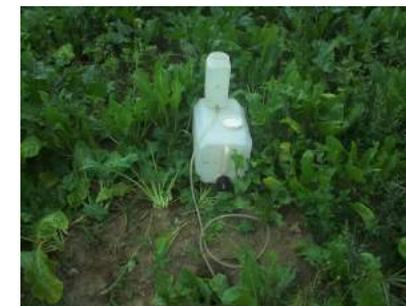
La campagne pédologique est composée de tests de perméabilité et de sondages pédologiques. L’expérience consiste en la saturation du sol pendant plusieurs heures, puis en la mesure de la perméabilité du sol saturé (méthode Porchet par infiltromètre à niveau constant, situation pénalisante pour une gestion des eaux pluviales, la mesure s’effectuant sur sol déjà saturé).
